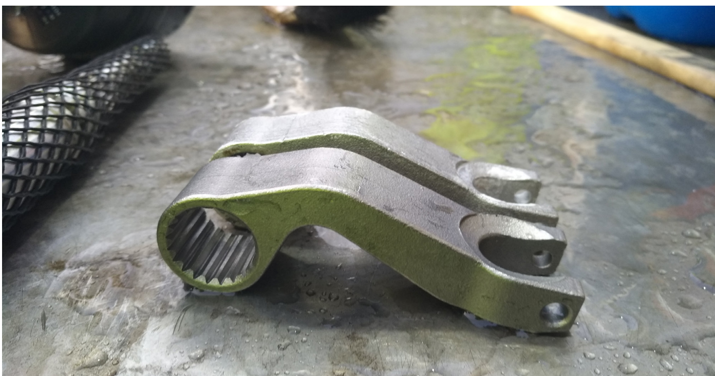
Vergelijksonderzoek tussen nieuw materiaal en onderdeel betrokken bij incident. (©VVA)
