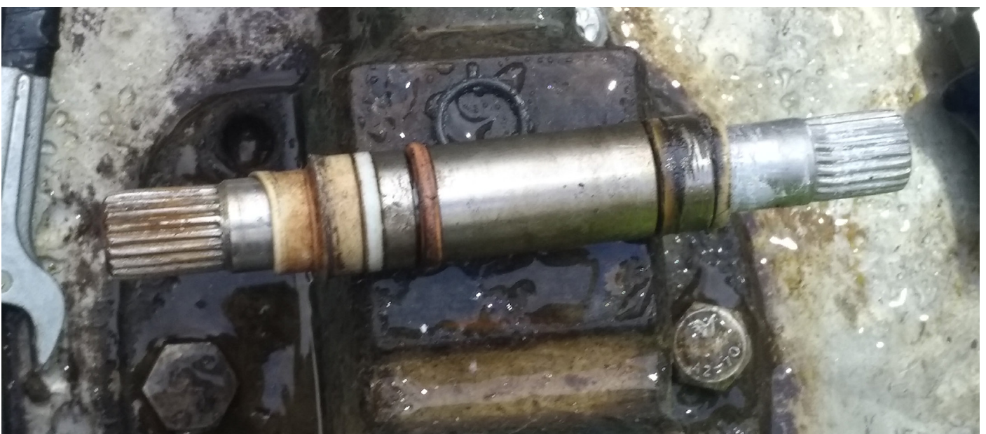
Onderzoek aan as vlinderklep toont aan: stand niet door geweld veroorzaakt. (©VVA)
