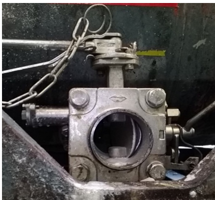
Open klep 'in positie gesloten'. (© VVA)
